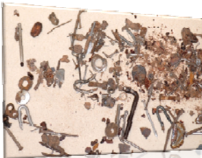
Metallische Fremdkörper Rohwarenkontrolle Schokoladenfabrik November 2007
