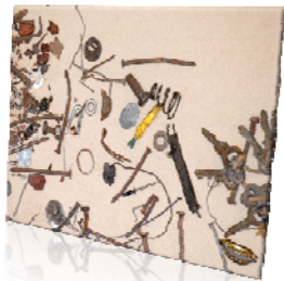
Metallische Fremdkörper Rohwarenkontrolle Schokoladenfabrik November 2007
